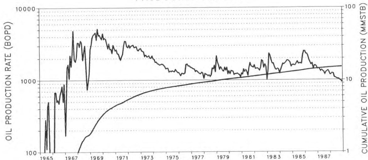
Figura 32. Historia detallada de producción de petróleo diaria (BOPD 75 ) y acumulada (MMSTB 76 ) del campo Ayoluengo desde su descubrimiento en el año 1964 hasta el finales del año 1988 (CHEVRON, 1989). A finales de 1988 se producían diariamente 1083 barriles de petróleo, 987 barriles de agua, 1,34 millones de pies cúbicos de gas y la producción acumulada del campo era de 15,1 millones de barriles. La producción alcanzó su flujo máximo en el año 1969, cuando se llegaron a producir 5200 barriles de petróleo al día.
