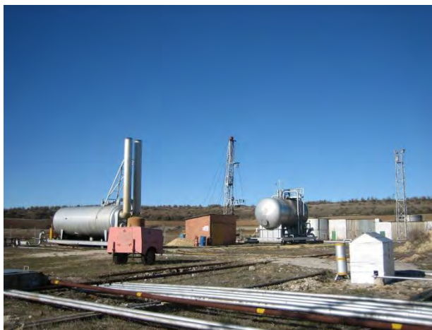
Figura 38. Aspecto general de las instalaciones del campo de Ayoluengo. A) En la foto de la izquierda se pueden observar el calentador de crudo (con dos tubos verticales) y el tanque del separador de gotas (derecha). Al fondo en el centro se observa la torre del equipo Cardwell kb200B que dispone el campo para intervenir en los pozos. B) En la foto de la derecha se observa en primer término las torres de separación de líquido/gas y a la derecha los tanques de almacenamiento.
